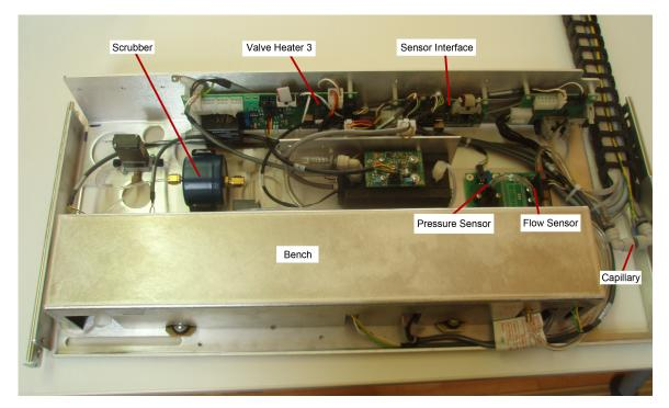
Figure 11.21.: Complete O<sub>3</sub> Module
