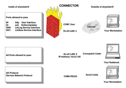
Figure 6.11.: Firewall Connection
