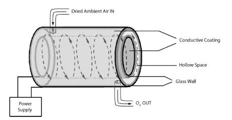
Figure 10.12.: Ozone Generator Principle
