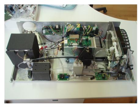
Figure 10.9.: Complete NO<sub>x</sub> Module
