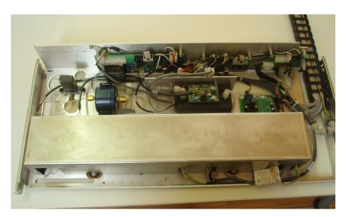
Figure 10.22.: Complete O<sub>3</sub> Module
