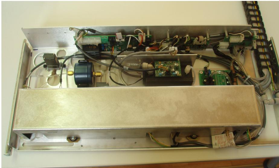
Figure 10.22.: Complete O<sub>3</sub> Module
