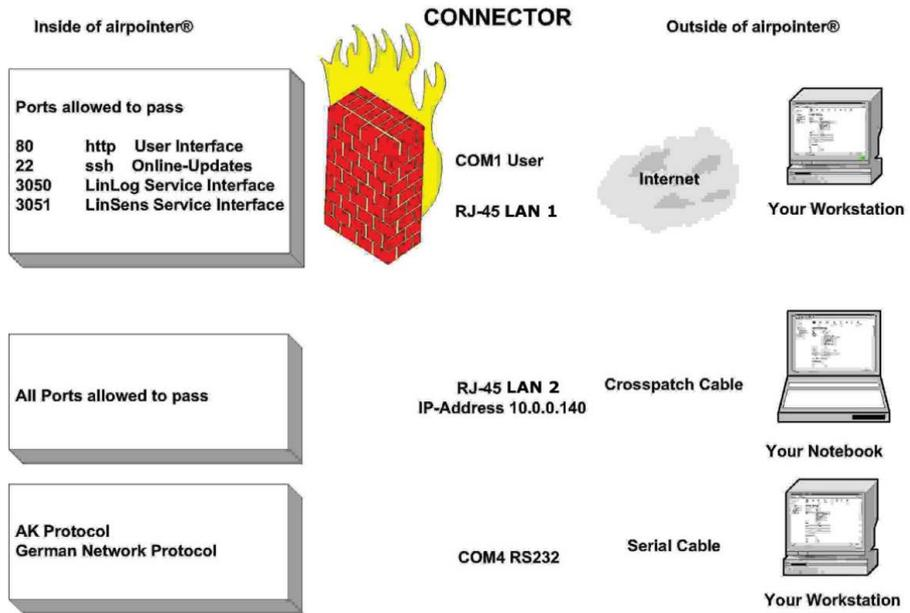
Figure 6.11.: Firewall Connection
