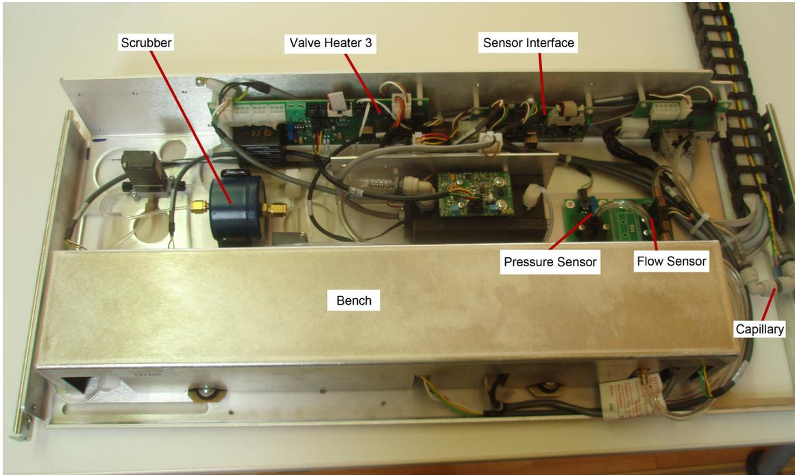
Figure 11.21.: Complete O<sub>3</sub> Module
