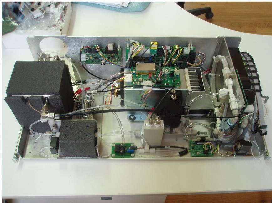
Figure 10.9.: Complete NO<sub>x</sub> Module
